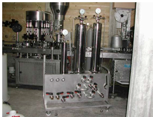
2-stufige Filterpalette - Weinfiltration Filterkerzenanlage mit Anschluss für Beistell-CIP-Einheit
