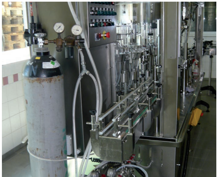
Flaschenfüller, Baujahr 2014, in Weingut mit zugestellter Stickstoff-Flasche
